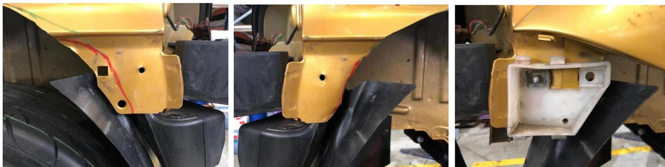
Los soportes del puente trasero serán los de serie, no estando permitidos de otro material que ofrezca mayor rigidez, al igual que su alojamiento será el original del coche, no está permitido hacer corredera en el sistema de anclaje del eje trasero a la carrocería.
