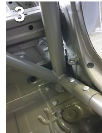
Anclaje lateral izquierdo
