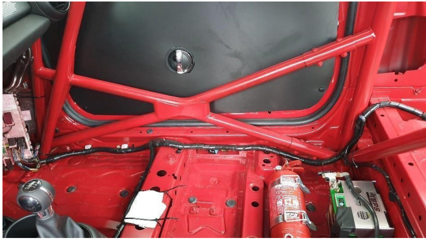
Enrutado de cables lado copiloto
