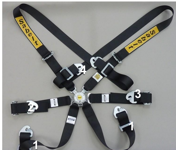
Identificación de los puntos de anclaje del arnés
