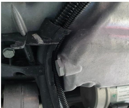
Tapón de vaciado del cárter
