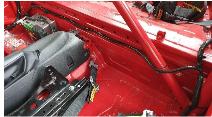
Paso de cables detrás del asiento
