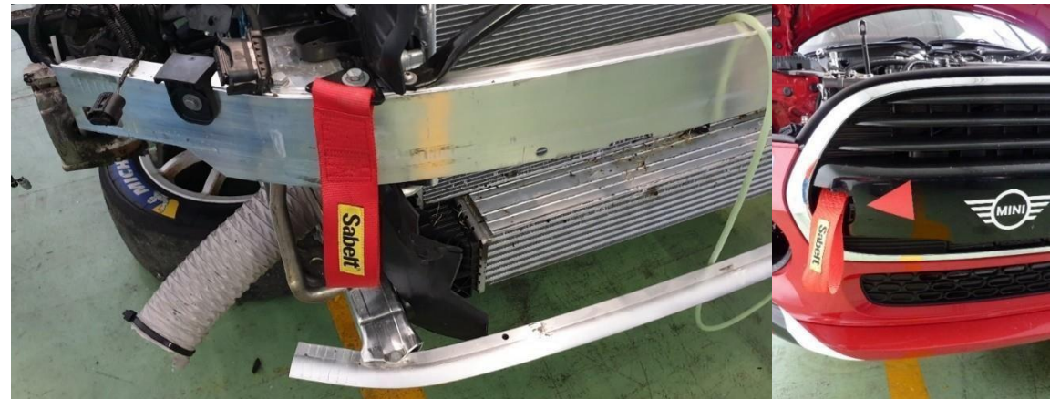
Punto de remolque delantero
