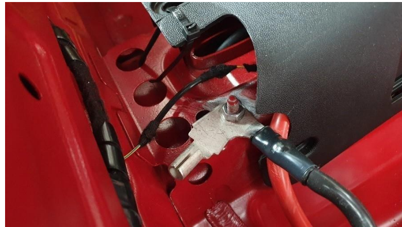
Nueva masa para la batería
