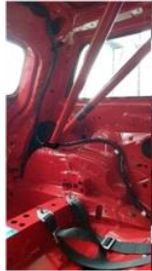
Cableado en la zona del portón trasero
