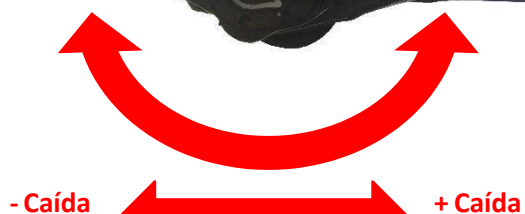
Modificación de caída tren trasero
