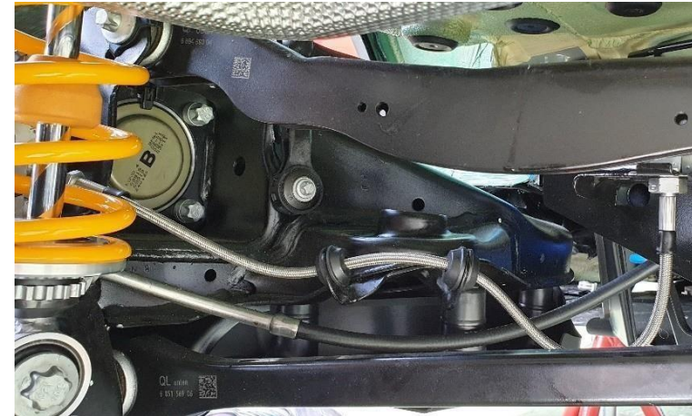
Enrutado latiguillo de freno trasero
