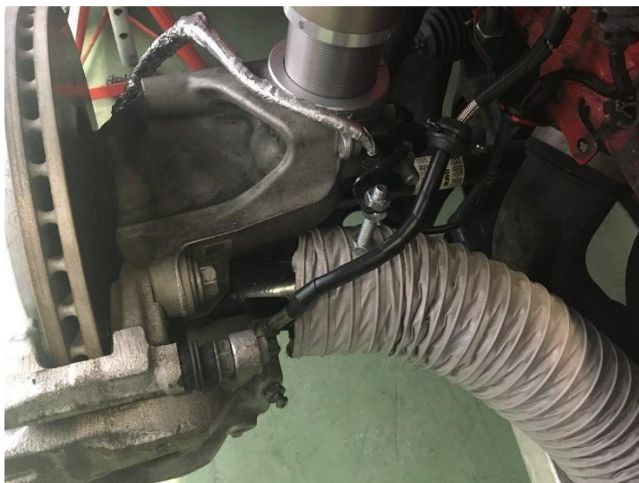
52. Detalle montaje tubo refrigeración frenos delanteros
