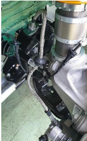
Enrutado latiguillo de freno delantero
