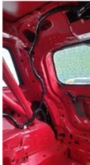
Cableado en la zona del portón trasero
