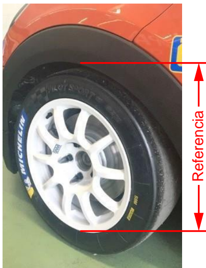
Referencia de altura en aletín delantero
