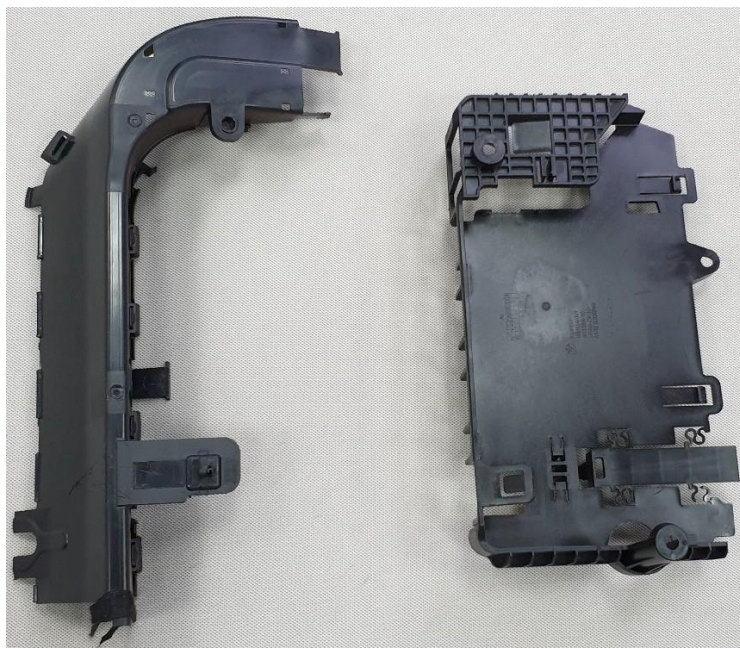
Piezas a eliminar en la zona de los pies del copiloto
