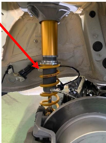
Cambio de altura trasera
