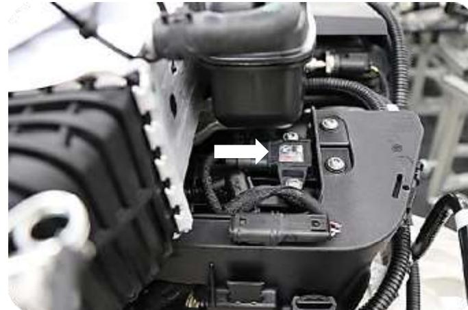
P/T-Sensor Intake (1x Hologram)
