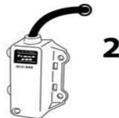
3. Conectar el Transponder a la batería del coche **directamente sin usar ningún tipo de relé, conmutador o paso intermedio** y comprobar que el led incorporado se ilumina en verde.
