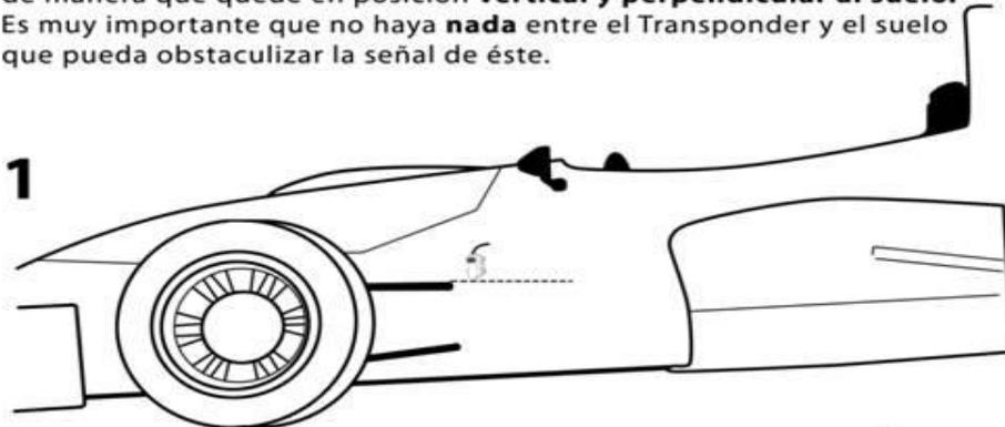
2. Hacer un agujero en la carcasa del coche para pasar el cable del transponder hacia la batería y conectarlo a esta (fig.2). Fijar el transponder lo más fuerte posible.
