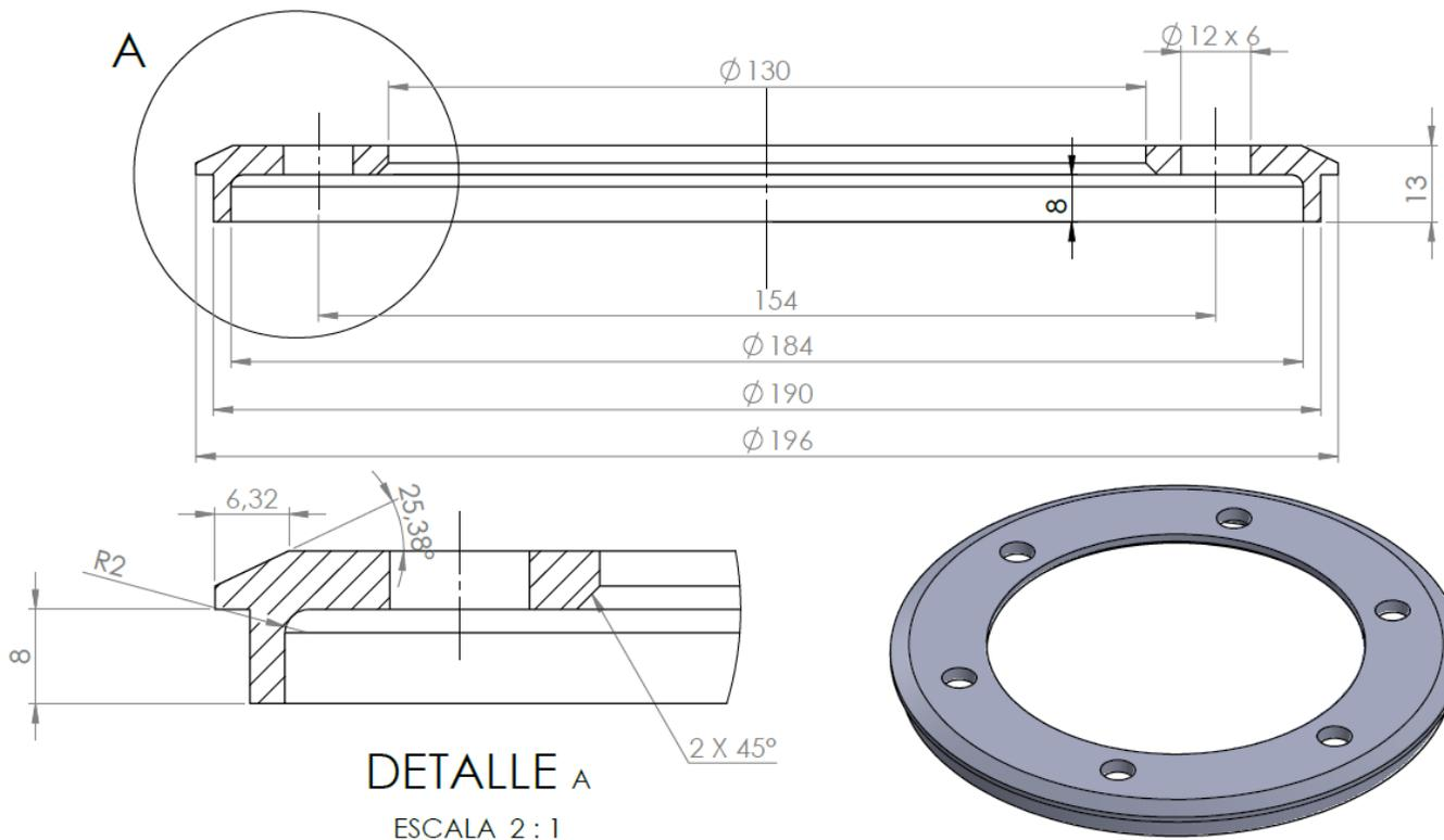
La separación entre los taladros de 12 mm será de 60° con respecto al eje de revolución de la pieza.
