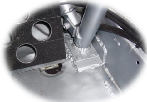
Fijación atornillada mediante pie de anclaje con placa de refuerzo en forma de cajetín
