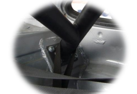
Fijación atornillada de tirantes traseros mediante pie de anclaje y placa de refuerzo de 60 cm 2
