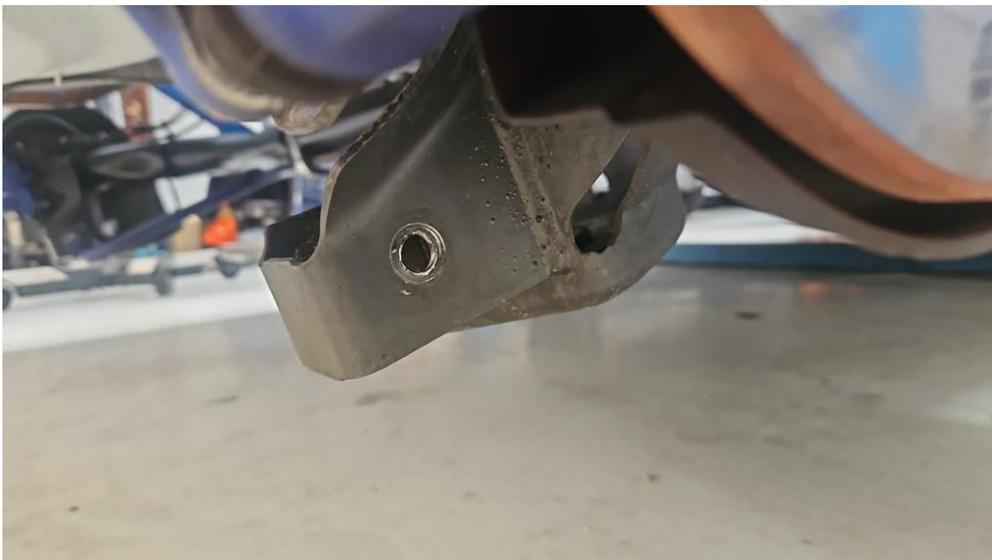
Se instalará un refuerzo en la base de las copelas delanteras suministrado en el KIT. Las copelas serán las suministradas en KIT con la suspensión, quedando prohibida cualquiera de otro tipo y su modificación.
