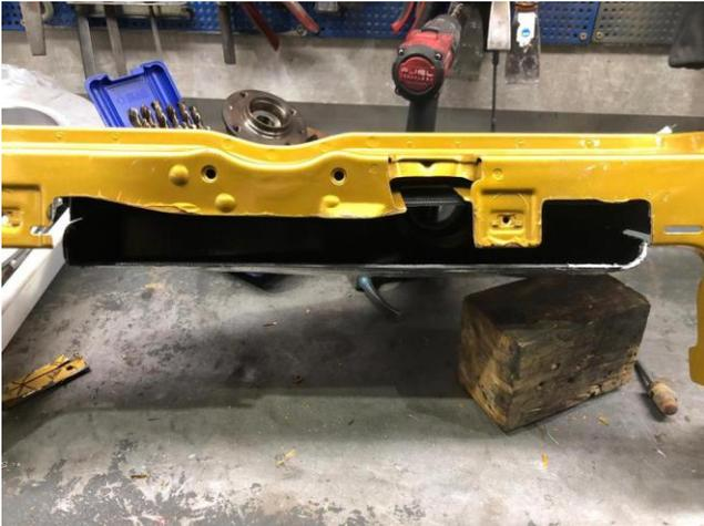
El soporte del electro puede ser cortado en caso de llevarlo por detrás del radiador.
