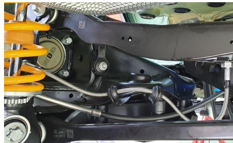
Enrutado latiguillo de freno trasero
