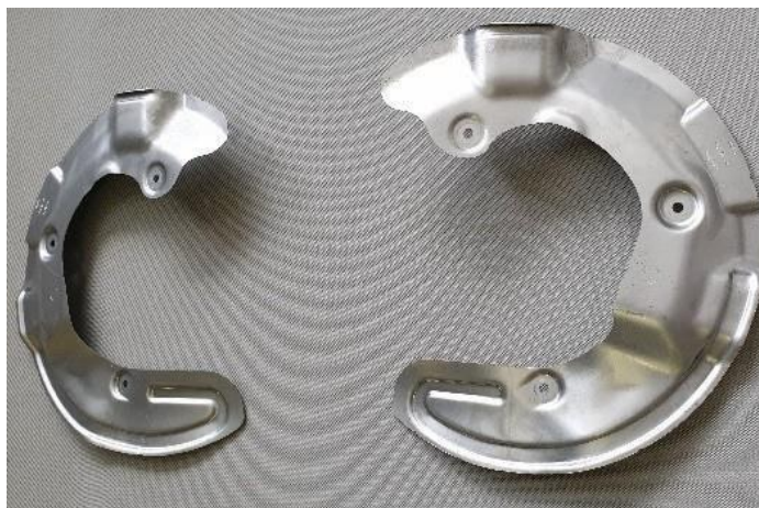
Protecciones de los discos de freno a eliminar
