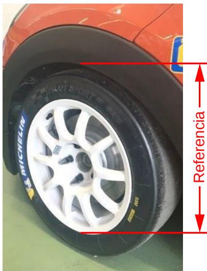
Referencia de altura en aletín delantero
