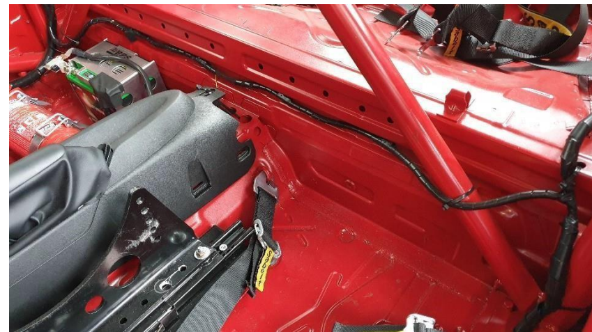
Paso de cables detrás del asiento
