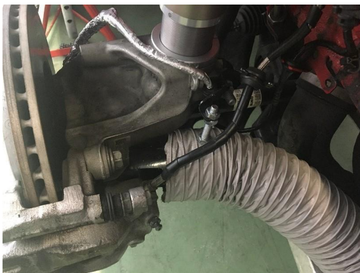
52. Detalle montaje tubo refrigeración frenos delanteros
