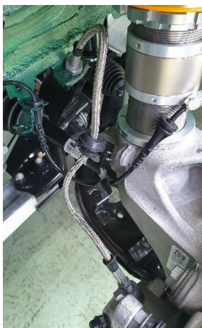
Enrutado latiguillo de freno delantero
