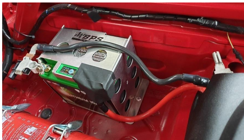
54. Nueva posición de la batería en el habitáculo
