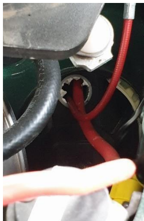
Detalle del paso al habitáculo del cable positivo
