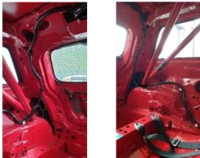
Cableado en la zona del portón trasero
