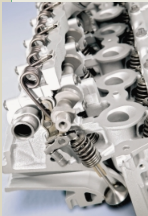
Vista parcial de una culata con el sistema de distribución por muelles y empujadores.
